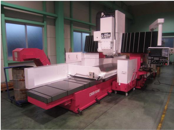
本機はテーブルサイズ1000mm×2400mmのNCプラノミラー「C25N」に切削油装置とバキューム付きマグネットチャックを装備した特殊仕様機になります。
