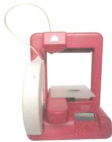
多岐にわたり、今年のJIMTOFでも沢山の最新機械が展示されると思います。材料は金属や樹脂、形状も丸材、角材、異形のものなど幅広く対応し、様々な部品を製作することが可能です。色々な機械がありますが、基本的に共通していることは目的の形状にするために材料から不要な部分を除去するという事です。それに対し「3Dプリンター」は溶かした材料を積層（積み重ねる）することによって目的の部品を製作します。1層当たりの厚みは方式や精度によって幅があり、精度の粗いもので0.4mm、高精度のもので15μmといったところです。
